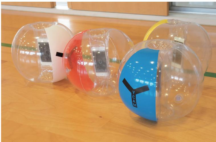
YCAMが開発したスマートフォンを埋め込んだビーチボール型ツール「YCAMボール」
