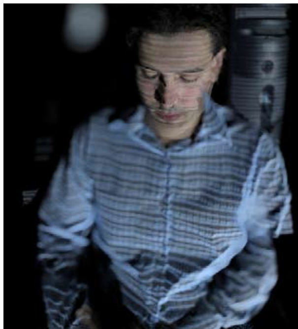
対象物を3次元で計測する3Dスキャナー技術「DIY 3D Scanning」による映像 (カイル・マクドナルド氏による開発)
